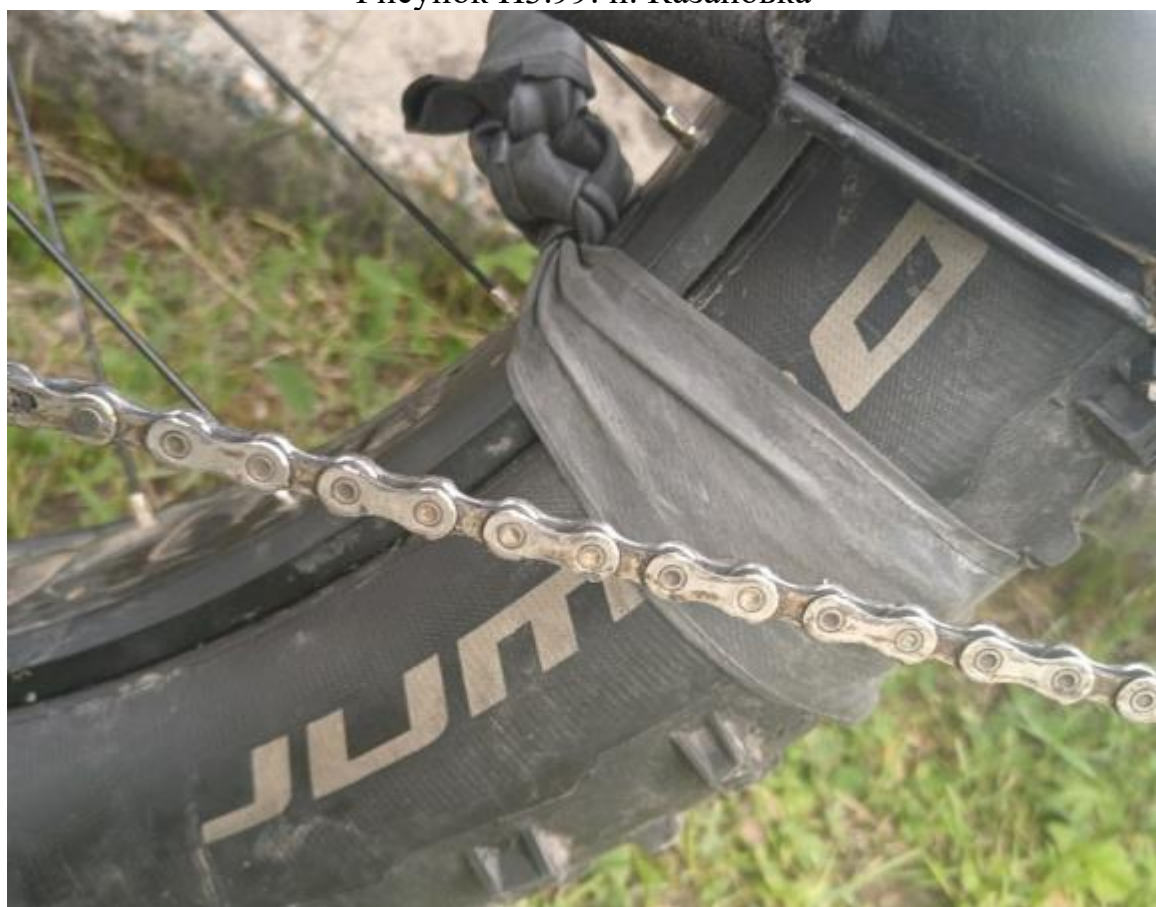
Рисунок ПЗ.100. Ремонт пореза бескамерной покрышки.
