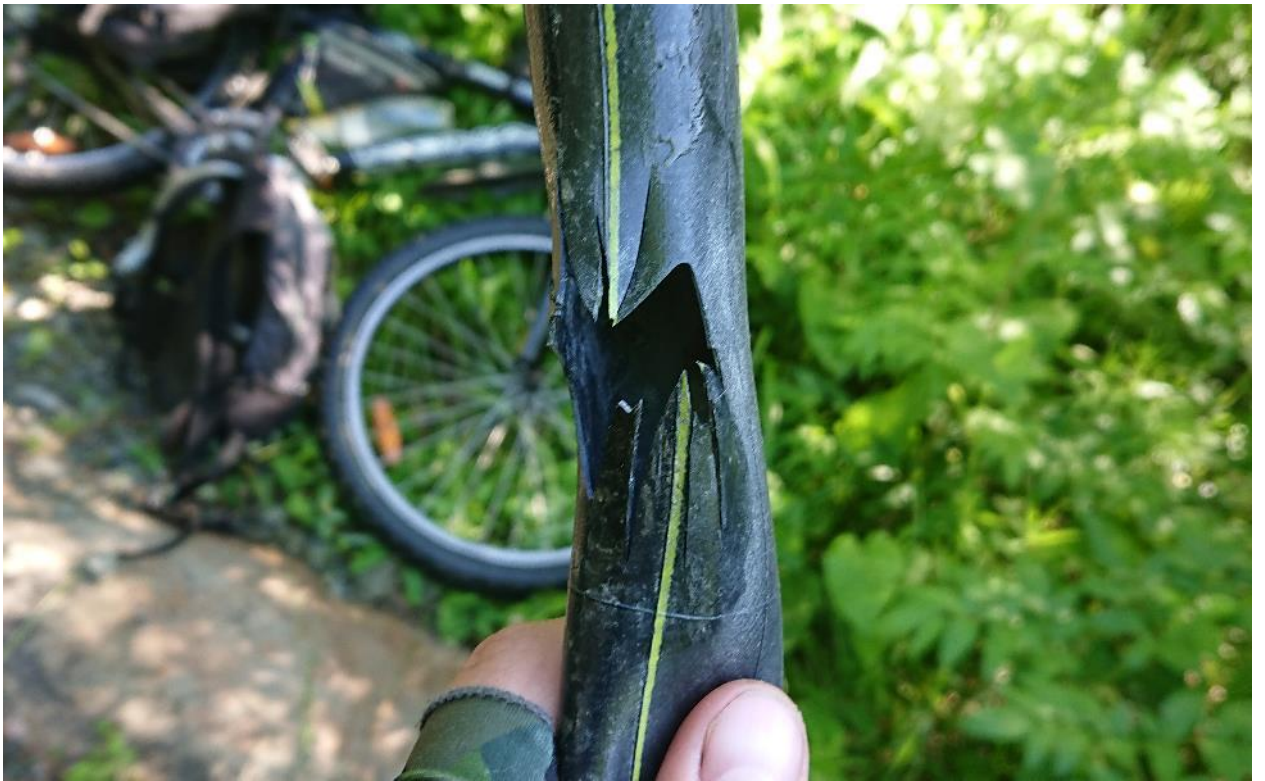
Рисунок 21. Разрыв камеры заднего колеса у Юрия.
