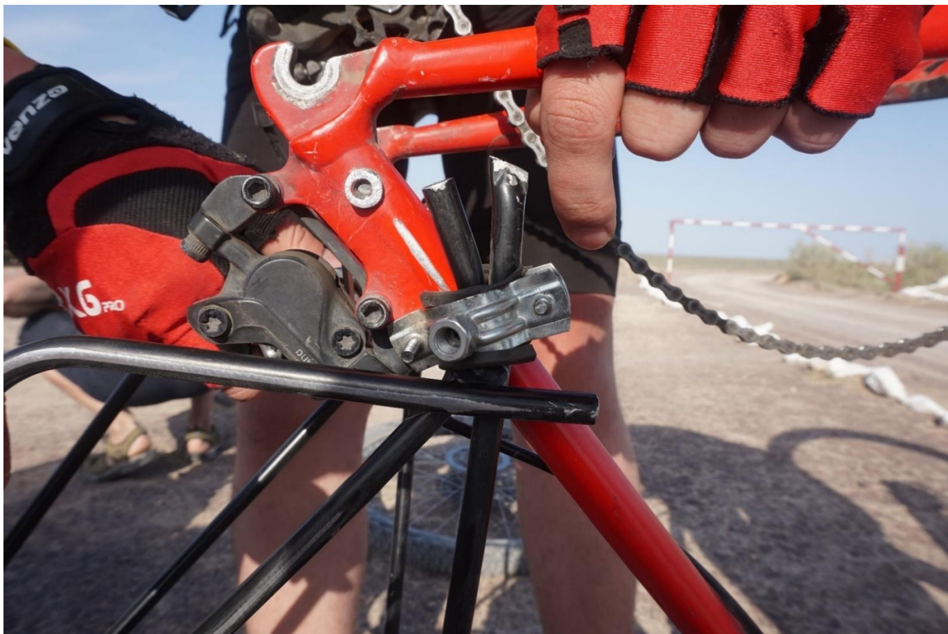
Фото 32. Оригинальное (а главное рабочее!) устранение поломки сантехническим хомутом.
